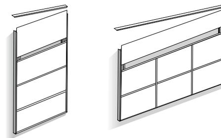
In runder oder eckiger Form bieten die Varianten Rondo und Facette eine ansprechende Gestaltung. Die verdeckte Montage sowie der präzise Gehrungsschnitt lassen diesen Rahmen an jeder Fassade auch mit größerer Entfernung zum Betrachter klar wirken. Optional ist eine LED-Beleuchtungseinheit möglich.
